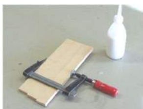
Verleimen der Grundplatte
